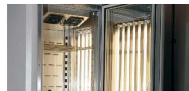
FIT DS - ajtóba és oldalfalakra szerelt fénycsövek
