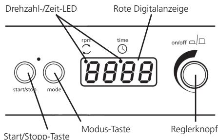
13. Drücken Sie die Taste „mode“ (Modus), bis ein roter Punkt am Display unter „rpm“ (U/Min) angezeigt wird. Am Display erscheint danach die zuletzt eingestellte Drehzahl.
