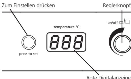
5. Lassen Sie die Taste „press to set“ (zum Einstellen drücken) los. Der Inkubator beginnt mit der Erwärmung auf die eingestellte Temperatur. Die tatsächliche Temperatur in der Kammer wird am Bildschirm angezeigt.
