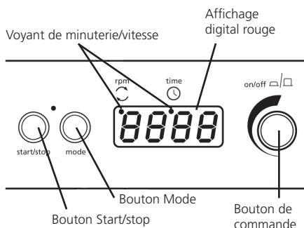
13. Appuyez sur le bouton « mode » jusqu'à ce qu'un point rouge apparaisse sur l'écran d'affichage, sous l'indication « rpm ». L'écran d'affichage indique alors la dernière vitesse définie.
